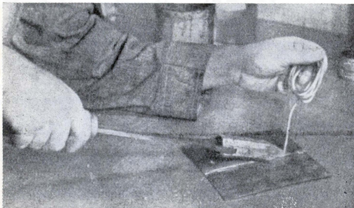
Foto 8 - La saldatura deve essere applicata proprio sul davanti del ferro da saldare. Questo deve essere tanto caldo da fonderla quando, procedendo lungo il giunto, ne viene a contatto.
